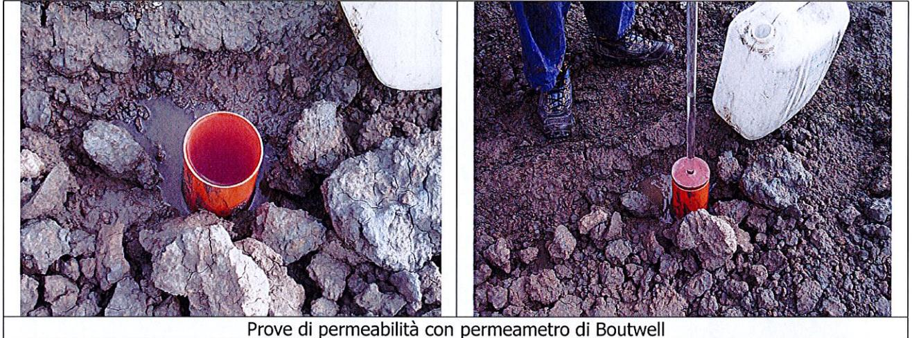
Prove di permeabilità con permeometro di Boutwell
